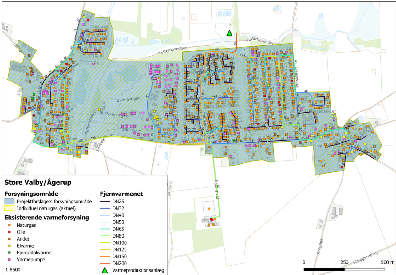
Figur 1: Projektforslagets forsyningsområde, eksisterende varmeforsyning og foreløbige lokalisering af varmeproduktionsanlæg
